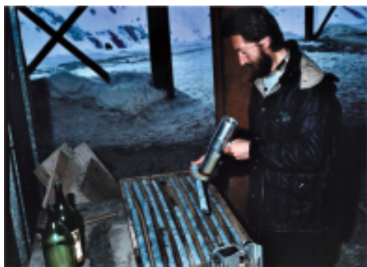
Fig.7 - valutazione radiometrica delle carote da sondaggio sul piazzale cantiere di Val Vedello con scintillometro SRAT Saphymo SPP2. Foto: C.M. Pessina
